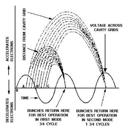
Figure 2-11.—Bunching action of a reflex klystron.
