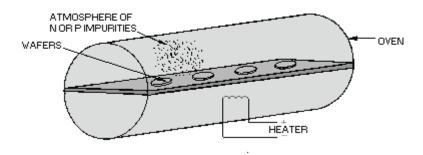
Figure 1-11.—Wafers in a diffusion oven.
