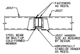
**JOIST SUPPORTED BY STEEL BEAM (UPSET SHALLOW BEAM)**
