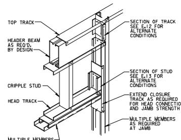
**AXIAL LOAD BEARING JAMB & HEAD**
