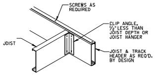
**JOIST TO JOIST HEADER**
