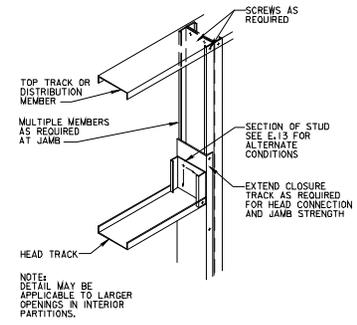
**NON-AXIAL LOAD BEARING JAMB & HEAD**
