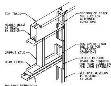
**AXIAL LOAD BEARING JAMB & HEAD**
