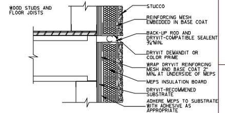
**INTERMEDIATE LEVEL WOOD FRAMING EXPANSION JOINT AT FLOOR LEVEL**
