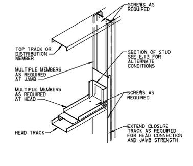
**NON-AXIAL LOAD BEARING JAMB & HEAD**
