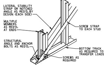
**DIAGONAL STABILITY BRACING ANCHORAGE AT BASE**
