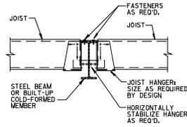
**JOIST SUPPORTED BY STEEL BEAM (UPSET DEEP BEAM)**
