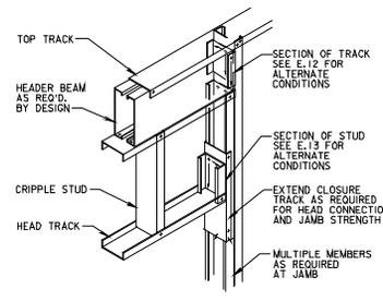
**AXIAL LOAD BEARING JAMB & HEAD**
