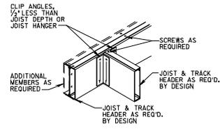
**JOIST HEADER TO BUILT-UP JOISTS**
