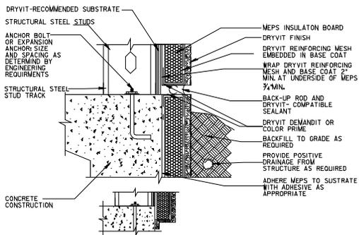
**GRADE LEVEL LIGHT GAUGE EXPANSION JOINT FRAMING AT CONCRETE SLAB**
